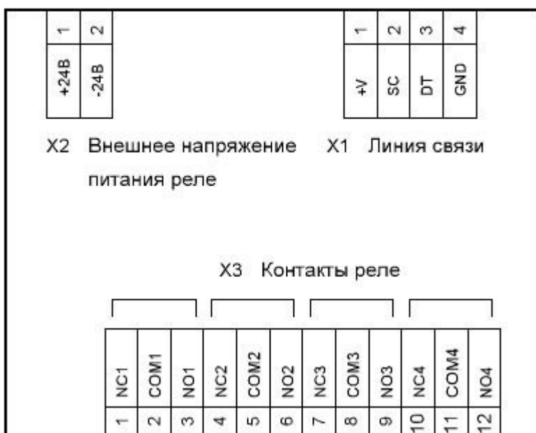
Схема подключения модуля дискретных выходов
