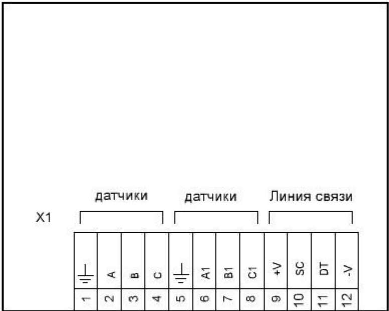
Схема подключения коммутатора СКВН
