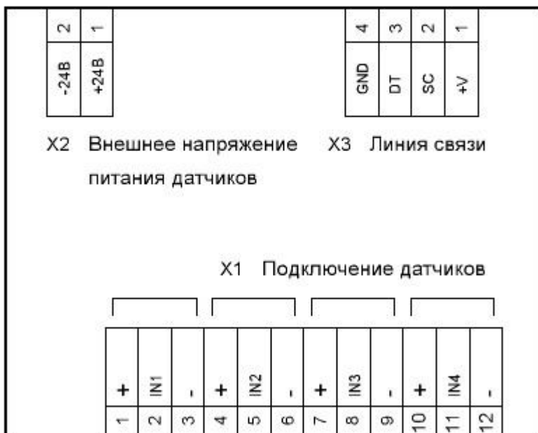
Схема подключения модуля дискретных входов
